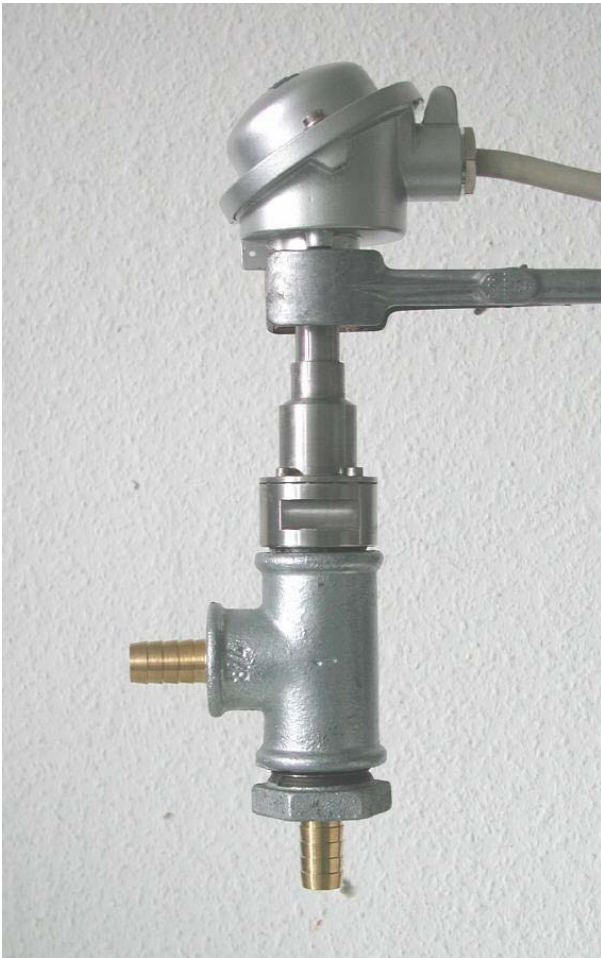
Sensor in Durchlauf - Messzelle
