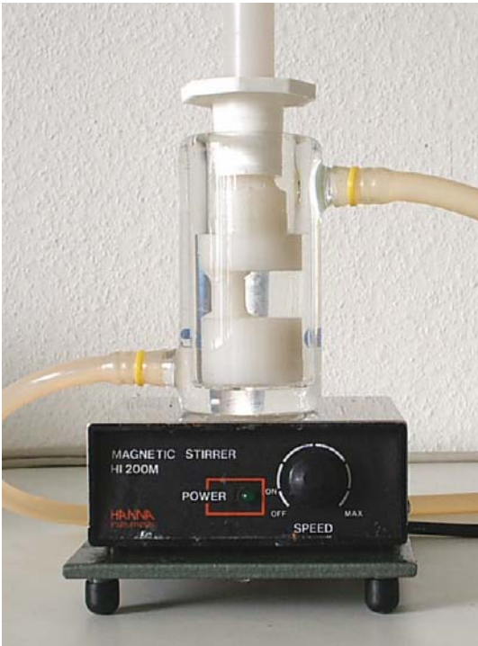
PVDF – Sensor im Reaktionsgefäß
