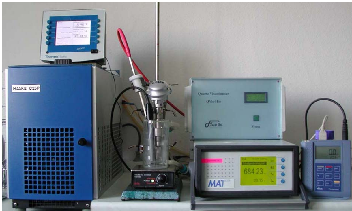
Abbildung 1 Meßplatz mit Schallgeschwindigkeits, Viskositäts- und Leitfähigkeitsmessung
