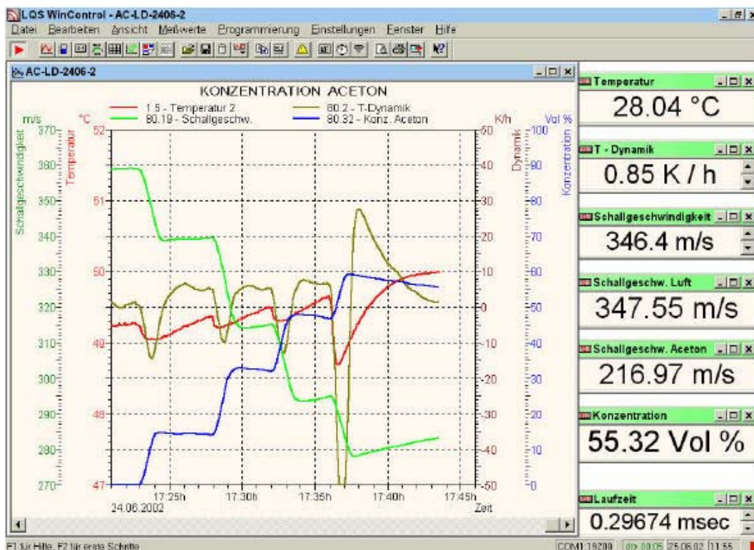
Abbildung 4 Konzentrationsbestimmung von Aceton in Luft
