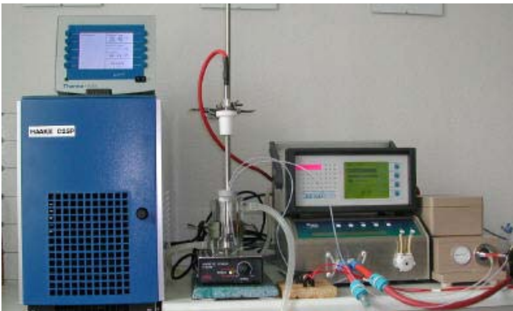
Abbildung 1 Labor – Messplatz Schallgeschwindigkeit, Dichte, Brechzahl
